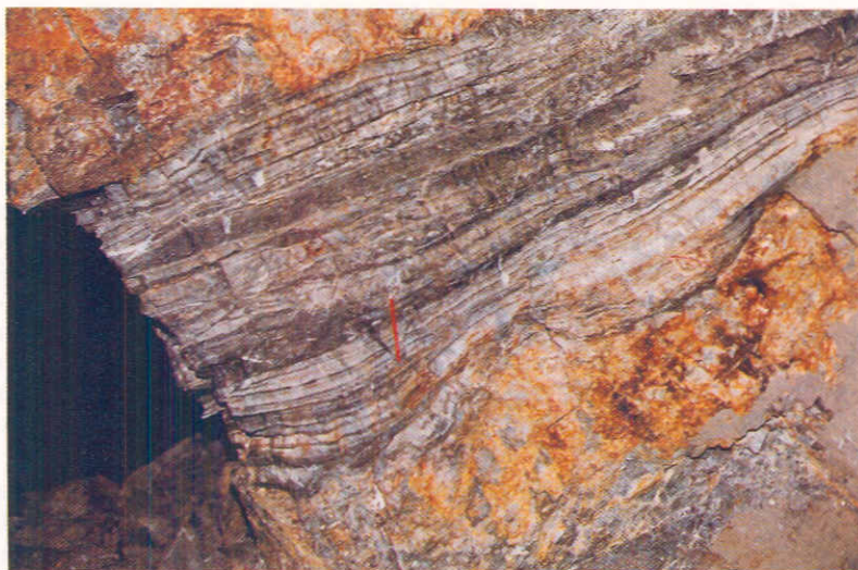
Sl. 6. Zahodno rudno telo z lepo izraženo plastnato teksturo. Talninski in krovinski dolomit je obarval limonit svetlo rjavo. Odkop št. 2, obzorje 1144 m, 2. podetaža
