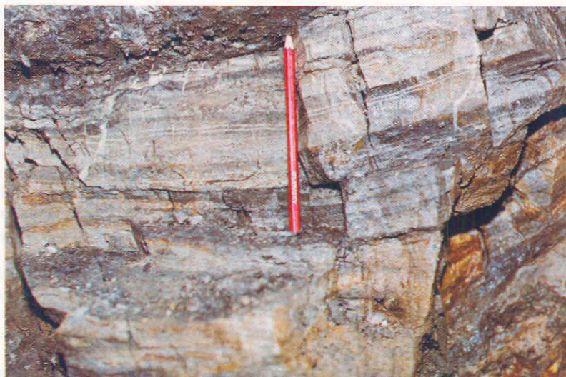
Sl. 7. Detajl sl. 6 kaže svetlo in temno sive plasti in lamine. Svetlo sive vsebujejo več sfalerita, temno sive pa več dolomita in glinenih mineralov
